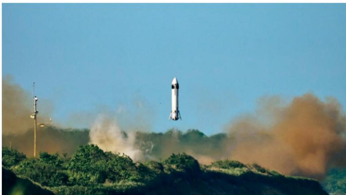
Le prototype de fusée réutilisable, développé en toute discrétion par Honda, s'est posé avec une précision de 37 cm après un vol de 56,6 s.
